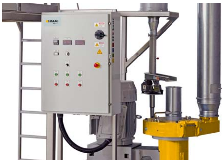
Mühlengehäuse und manuelle Steuerung
