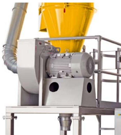
Gebläse, Zyklon und Förderleitung
