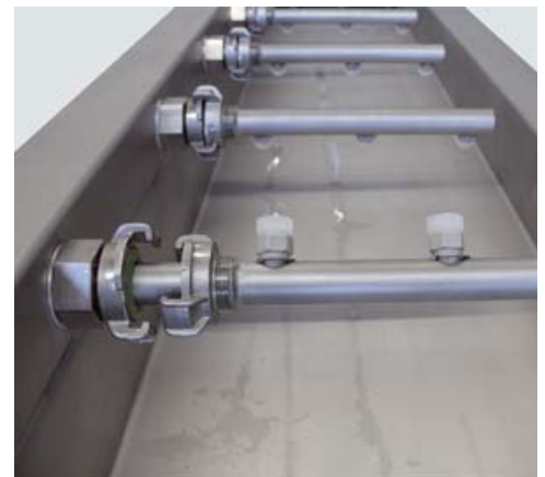
Schnellwechselsprühdüse für einfache Wartung im Betrieb
