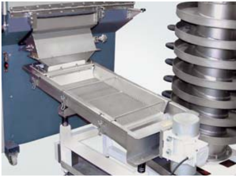
Siebmaschine und Wendelförderer zur Granulat-Weiterverarbeitung
