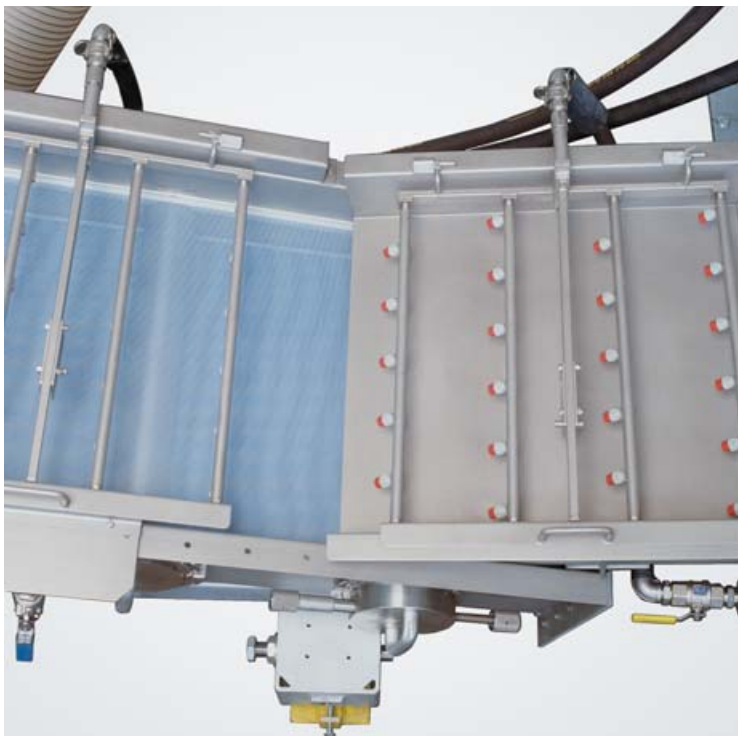
Blick auf den Übergang von der Leiteinrichtung zum Strangförderband einer JSG 600
