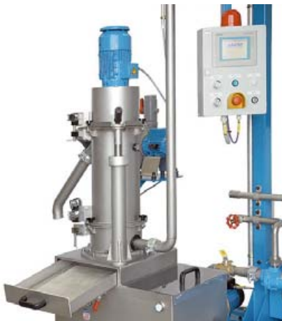
Feinstteile-Filterung in den Wassertank eingebaut
