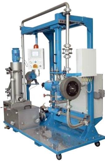
LPU™ Schmelzezuführung zur Lochplatte
