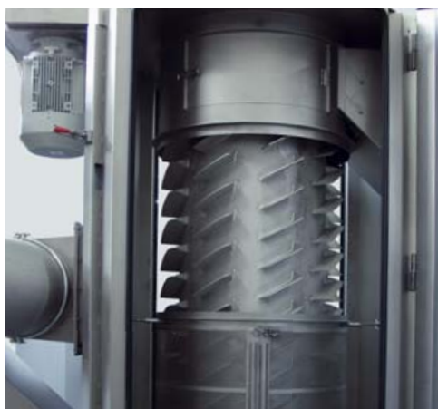
Rotor und Sieb im Inneren des CENTRO Trockners
